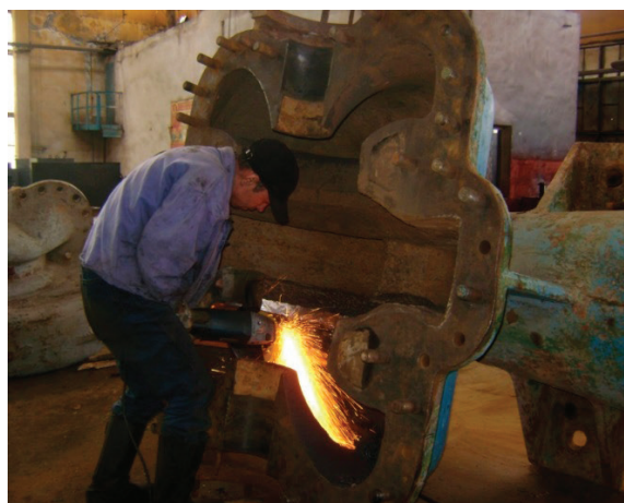
Рис. 3. Механическая обработка внутренней поверхности
