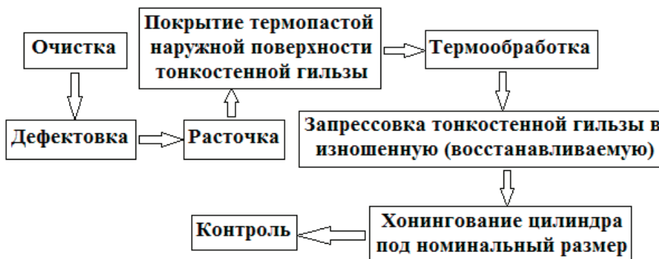
Рис. 2. Модернизированный способ восстановления гильзы цилиндра
